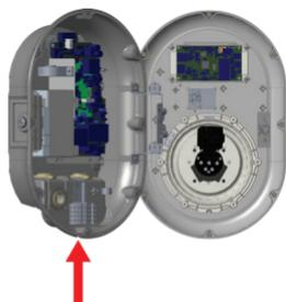
**2-** Pase el cable a través de las abrazaderas de cable tal como se indica por las flechas de la siguiente figura-
